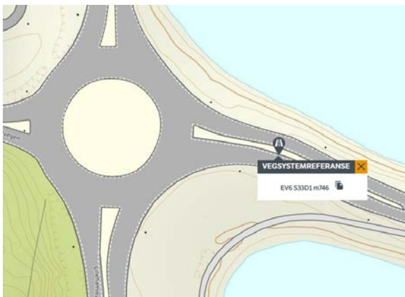
Figur 2: Grafisk fremstilling av en strekning innenfor et Vegsystem. Strekningsnummer er et unikt nummer for en strekning i et vegsystem for ERF-veger på landsbasis. F.eks. finnes S2 for EV6 kun et sted i landet. Delstrekningsnummer deler opp strekningen etter vegens funksjon, f.eks. hovedløp, armer og gang- og sykkelveger. Normalt sett vil hovedløpet på vegen være delstrekning 1, mens delstrekningsnummer for armer tildeles fortløpende. Delstrekning for gang- og sykkelveger for KPS-veg tildeles også delstrekningsnummer fortløpende, mens de for ERF-veg får delstrekningsnummer > 100. I eksempelet har armen fått delstrekningsnummer 10, og gang- og sykkelvegene delstrekningsnummer 100, 120 og 130.
